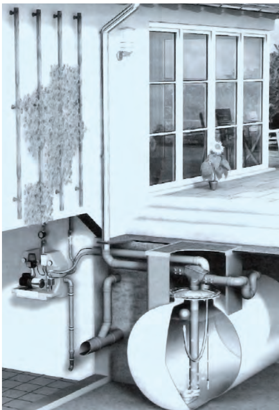
Schnitt durch ein Wassertanksystem im Einfamilienhaus
